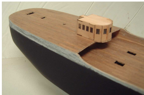
Fase n° 2 – ottobre /novembre 2001 copertura dello scafo con la seconda listellatura e rivestimento del ponte, stuccatura e rifinitura dello scafo con carta vetrata, prima verniciatura a spruzzo (nero) ed imbastitura delle sovrastrutture.
