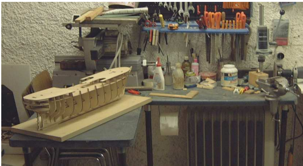
Fase n° 1 – Agosto 2001 assemblaggio delle ordinate, del ponte e prima listellatura.
