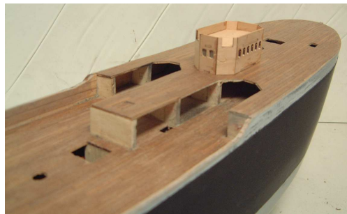
Fase n° 2 – ottobre /novembre 2001 copertura dello scafo con la seconda listellatura e rivestimento del ponte, stuccatura e rifinitura dello scafo con carta vetrata, prima verniciatura a spruzzo (nero) ed imbastitura delle sovrastrutture.
