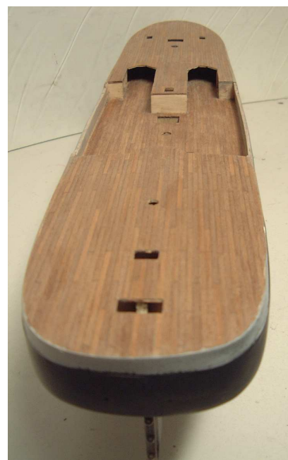
Fase n° 2 – ottobre /novembre 2001 copertura dello scafo con la seconda listellatura e rivestimento del ponte, stuccatura e rifinitura dello scafo con carta vetrata, prima verniciatura a spruzzo (nero) ed imbastitura delle sovrastrutture.
